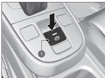
1 Commutateur du frein de stationnement électrique
