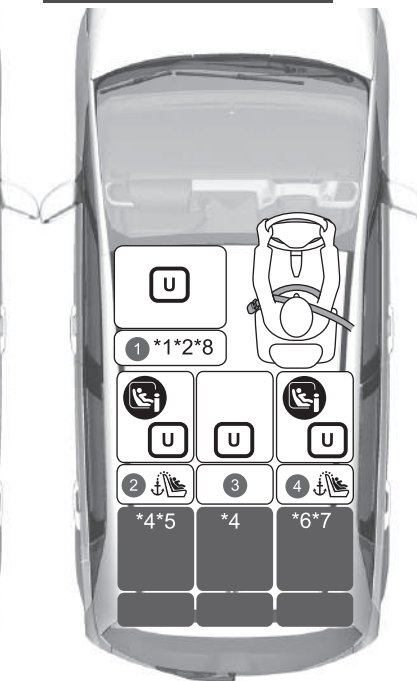
Airbag passager désactivé pour modèle à conduite à droite
