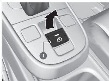
1 Commutateur du frein de stationnement électrique
