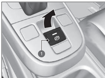
1 Commutateur du frein de stationnement électrique
