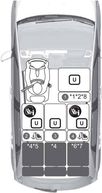
Airbag passager désactivé pour modèle à conduite à gauche
